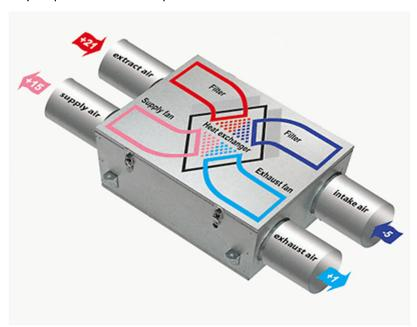
De esta manera se consigue disminuir el consumo de calefacción durante los meses de invierno, puesto que el aire exterior de renovación se precalienta en el recuperador, y en verano se reduce el consumo eléctrico asociado al aire acondicionado.
