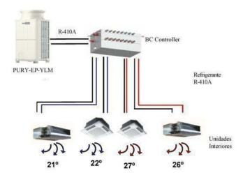
El edificio se climatiza mediante sistemas centralizados de VRV divididos por plantas o verticales con similares condiciones a climatizar y explotar
