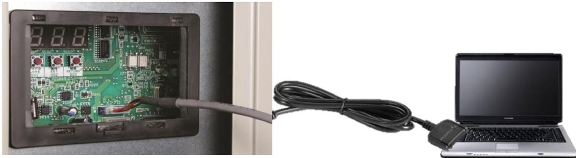
También es posible realizar la carga de refrigerante adicional y grabar los kg en la unidad para que, periódicamente, inicie un modo de comprobación de carga y, en caso de que exista diferencia, de un código de advertencia para llevar a cabo la comprobación por el operario.
