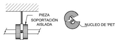
DETALLE DE SOPORTACIÓN DE CONDUCTO VERTICAL DE CHAPA DE ACERO AISLADA
