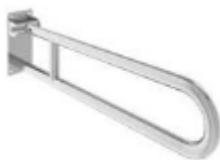
Barra doble abatible, de instalación mural, de 700 mm de longitud, fabricada en acero con acabado pulido brillo, 100% libre de bacterias, con accionamiento por muelle y bloqueo en posición vertical, con sistema antiatrapamiento de los dedos. Totalmente instalada sobre paramento; i/p.p. de fijaciones mediante tacos y tornillos y medios auxiliares. Conforme a CTE DB SUA-9
