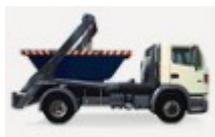
Camión de residuos. e descargará a su llegada a obra, desde los camiones de transporte, mediante grúa y elementos de izado adecuados. Posteriormente se realizará el proceso inverso de carga a los camiones, para su retirada de obra.
