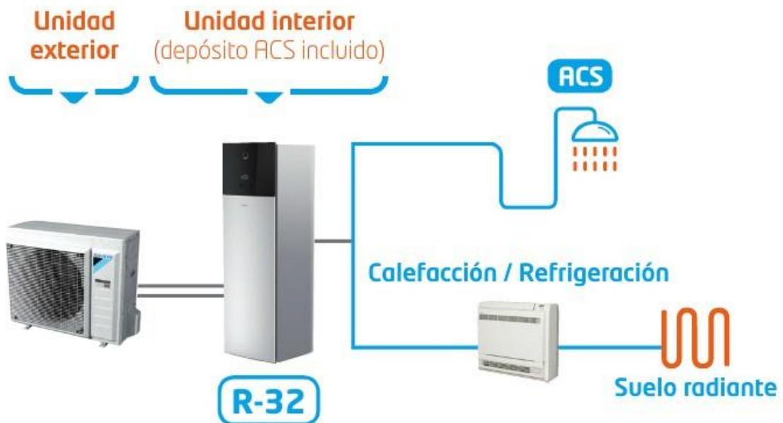
La unidad exterior extrae la energía del aire exterior y, con la ayuda de un compresor, esta energía se utiliza para calentar agua, cubriéndose las necesidades de calefacción y ACS. El Hidrokit transfiere este calor al circuito de agua conectado a los emisores de calor.
