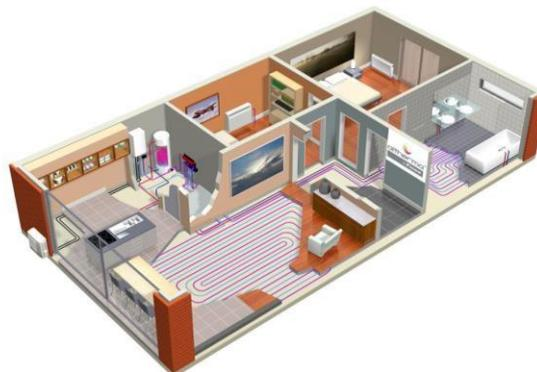
El Hidrokit puede cambiar la dirección de transferencia de calor para proporcionar refrigeración. La refrigeración se realiza mediante agua enfriada y unidades terminales fan coils de cualquier tipo (suelo, techo, etc...) o suelo refrescante.
