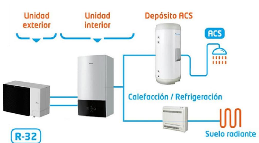
Por otro lado, las unidades de EBLADV son un sistema compacto de climatización y producción de agua caliente sanitaria. En estos equipos, las unidades exteriores y los hidrokits quedan unificados en un solo equipo. Al ser un sistema compacto con una sola unidad instalada en el exterior de la vivienda, no merma el espacio interior disponible. Se pueden combinar con depósitos de acero inoxidable EKHWS-D o depósitos de polipropileno EKHWP300-500B/PB.
