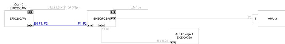
En caso de D-AHU, la caja EKEQ y la válvula EKEV se incluyen precableadas en el interior del AHU.
