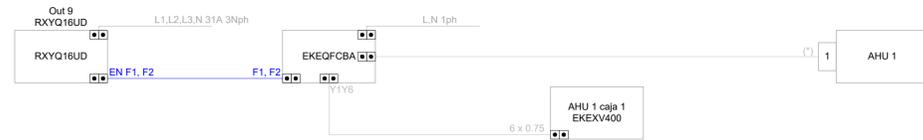
En caso de D-AHU, la caja EKEQ y la válvula EKEV se incluyen precableadas en el interior del AHU.
