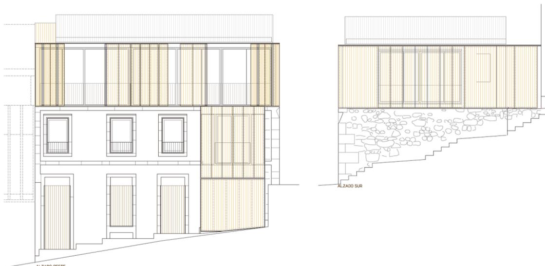
Así, aparece una fachada sur adaptada a la edificación colindante al este, con un cerramiento ligero apoyado en un plinto de piedra vista, destacado como muro de contención; y a continuación la fachada tradicional adaptada a la escala humana de la villa, empleando como elemento de costura la fachada de paneles abatibles.
