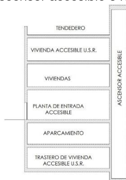
Figura 2. Ascensor accesible en edificios con viviendas accesibles para personas usuarias de silla de ruedas (USR)
